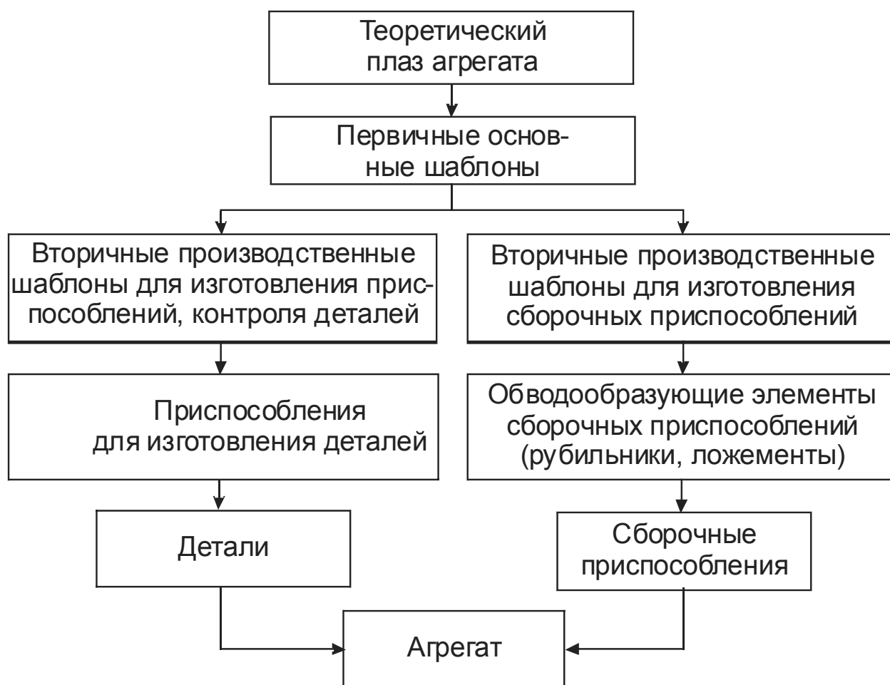
Рис. 7.4. Принципиальная схема ПШМ увязки
