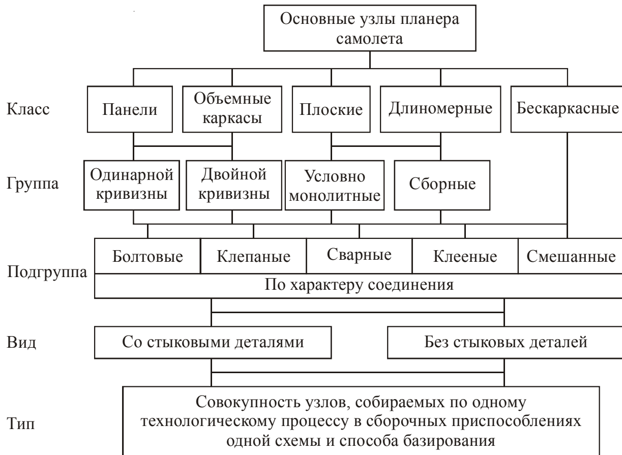
Рис. 25.1. Принципиальная схема классификации основных узлов планера самолета
