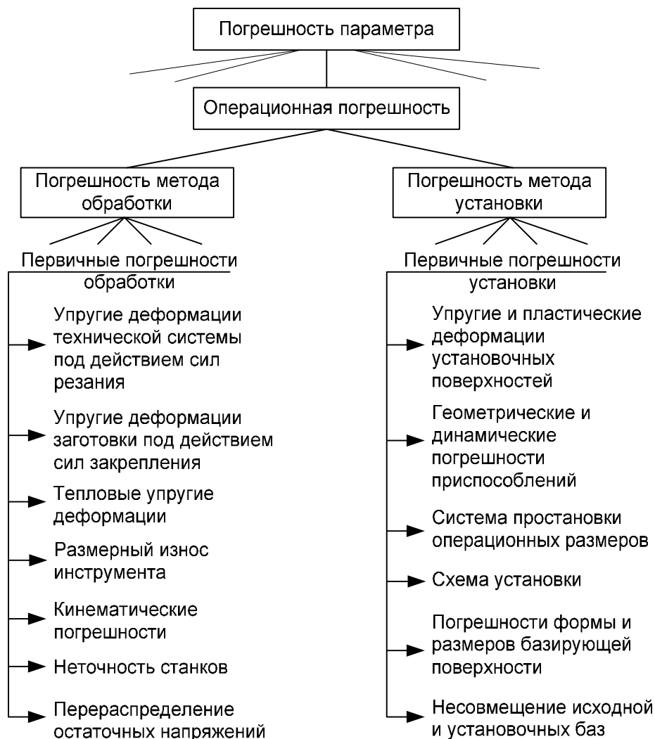
Рисунок 4.3 Схема классификации погрешностей
