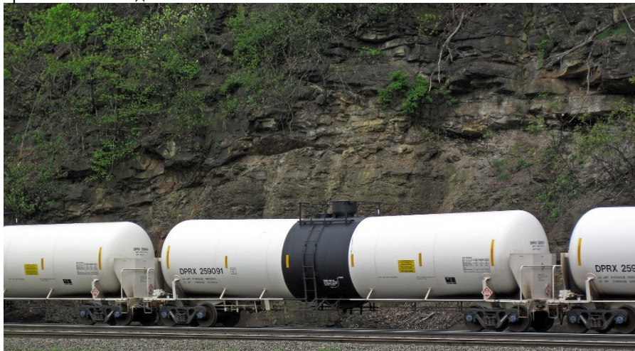
Вагони -цистерни з маркуванням UN номер 1267 - Сира нафта, перетинають Альтуну, штат Пенсільванія, на нафтопереробний завод
