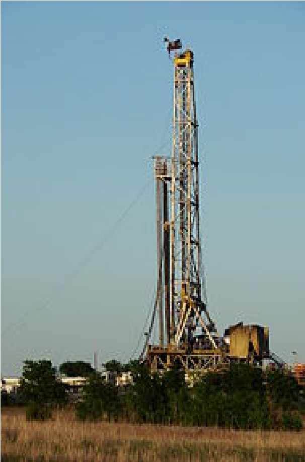
(Горизонтальна) бурова установка для природного газу в Техасі
