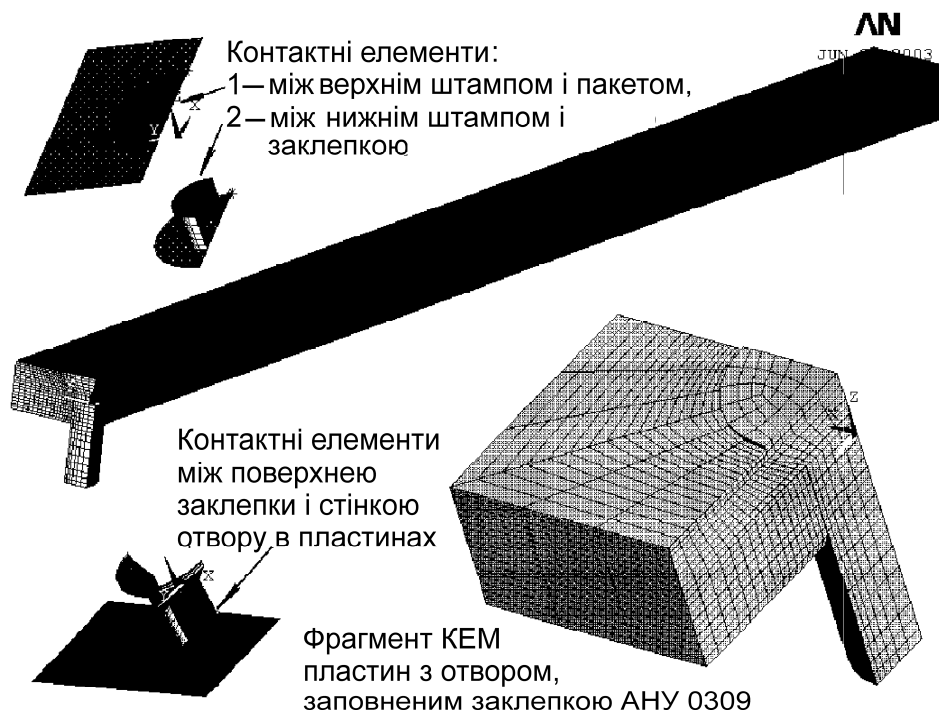
Рис. 2.62. Скінченноелементна модель заклепочного з'єднання
