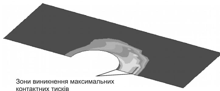
Рис. 2.106. Характер розподілу контактного тиску між накладкою і шайбою болта при дії розтягального навантаження в з'єднанні
