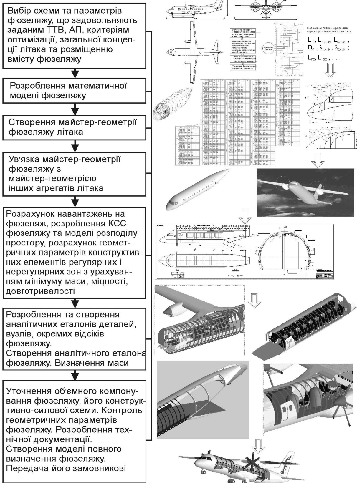
Рис. 2.9. Інтегрований метод проектування і комп'ютерного моделювання фюзеляжу за допомогою систем CAD/CAM/CAE
