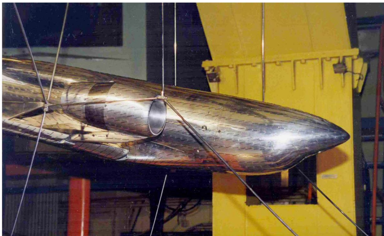
Рисунок 3.6 – Визуальные испытания модели самолета Ан-148 методом шелковинок в аэродинамической трубе АТ-1
