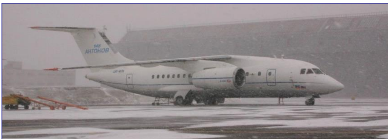
Рисунок 4.14 – Испытание самолета в условиях естественного обледенения при температурах до минус 20 °С (Архангельск, Нарьян-Мар (Россия))
