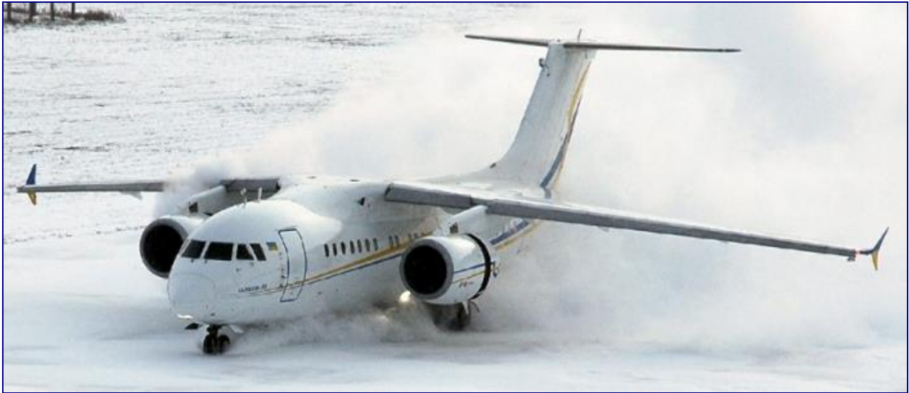
Рисунок 4.17 – Летные испытания на ВПП, покрытых осадками
