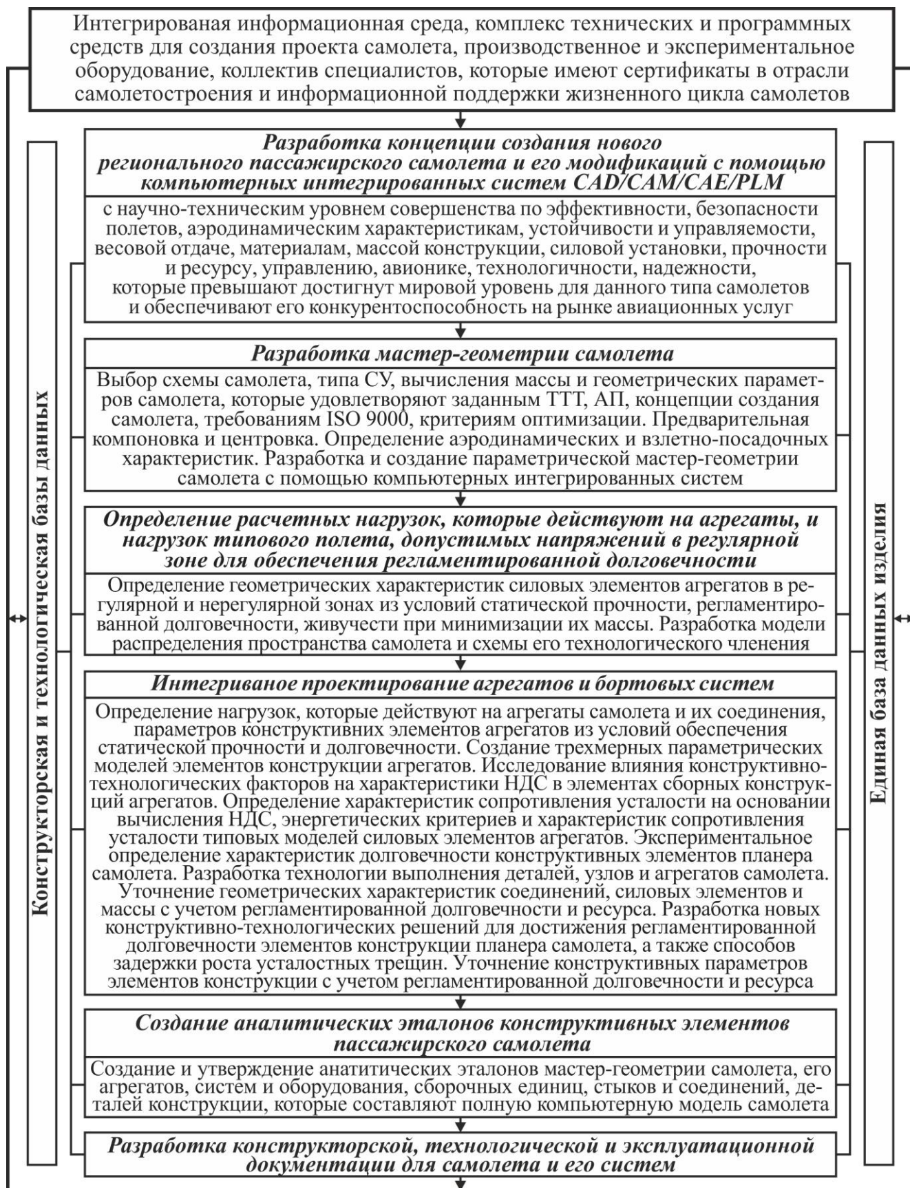
Рисунок 2.1 – Особенности концепции интегрированного проектирования базового регионального пассажирского самолета
