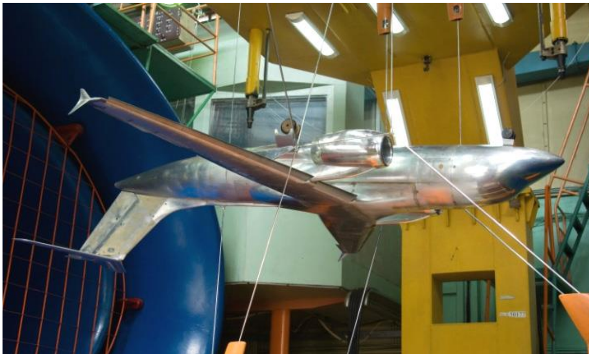
Рисунок 3.8 – Механизированная модель самолета Ан-158 в аэродинамической трубе АТ-1
