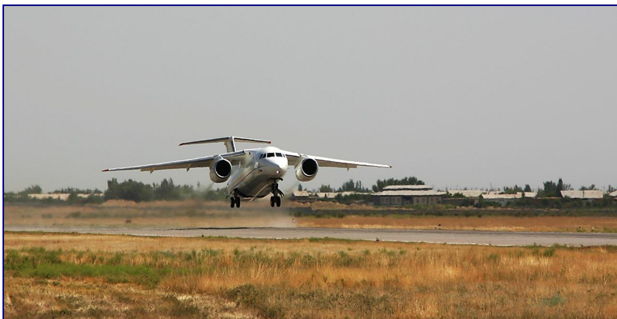
Рисунок 4.11 – Испытание при высоких температурах (до +45 °С)
