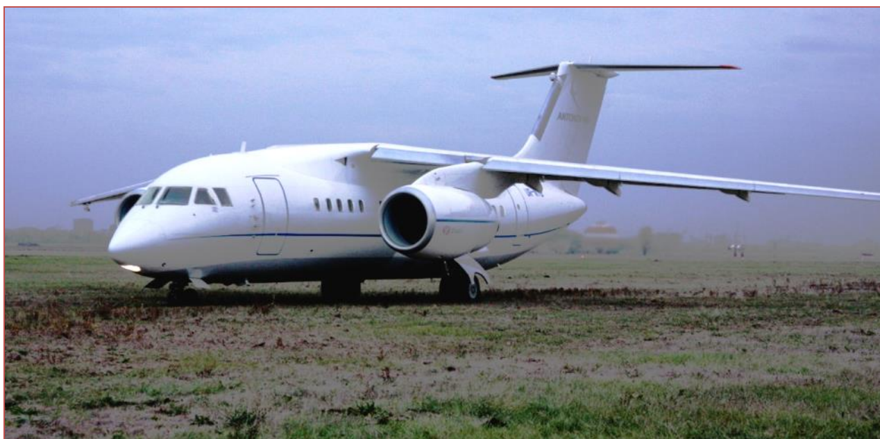
Рисунок 4.12 – Испытание на грунтовой взлетной полосе
