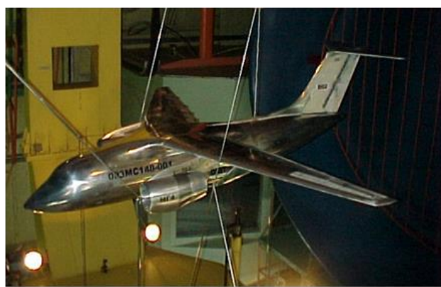
Рисунок 3.32 – Исследование моделей в аэродинамических трубах
