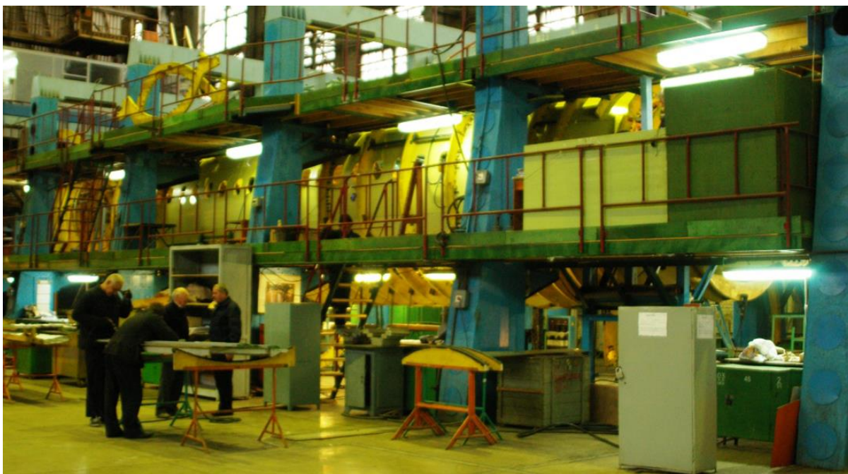
Рисунок 4.2 – Станция сборки и стыковки агрегатов фюзеляжа
