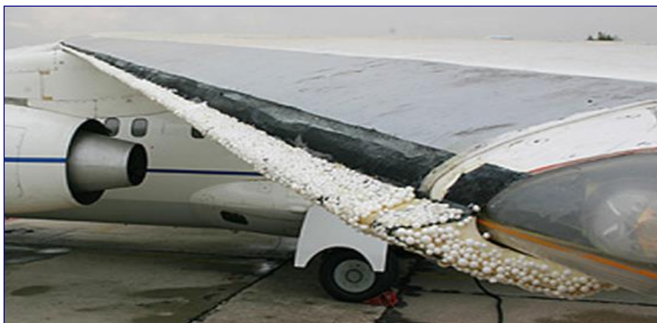
Рисунок 4.16 – Летные испытания с имитаторами льда
