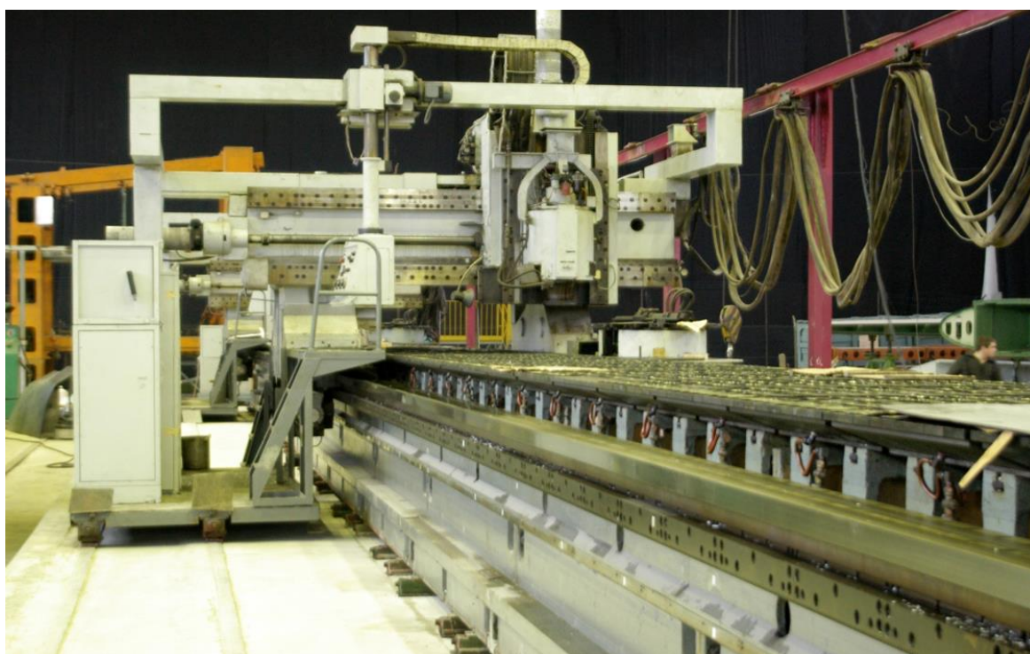
Рисунок 4.5 – Фрезерный станок из ЧПУ для изготовления длинномерных деталей крыла
