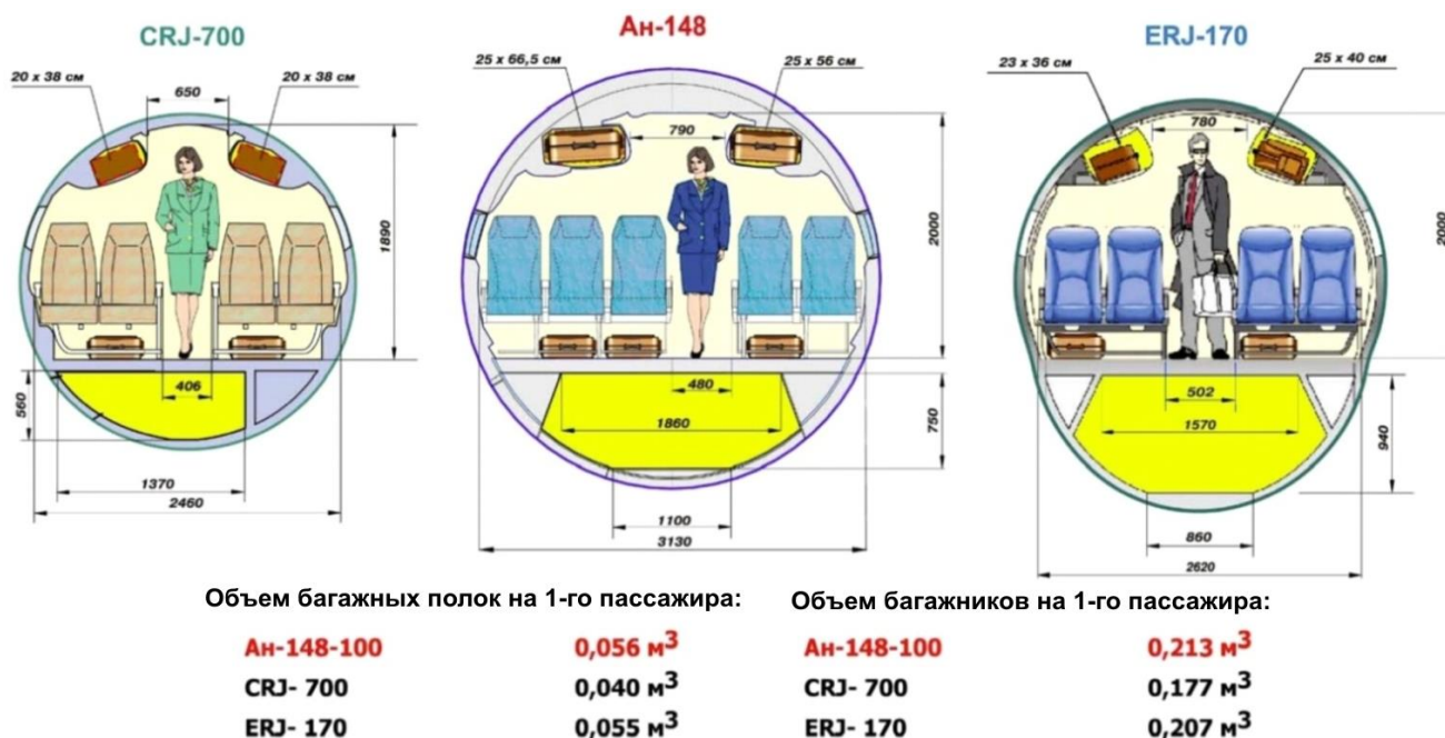
Рисунок 2.23 – Сравнение поперечных сечений фюзеляжей самолета Ан-148-100 и его аналогов
