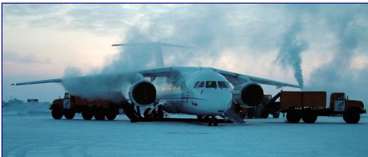
Рисунок 4.10 – Испытание при сверхнизких температурах (до минус 55 °С). Якутск, Нерюнгри (Россия)
