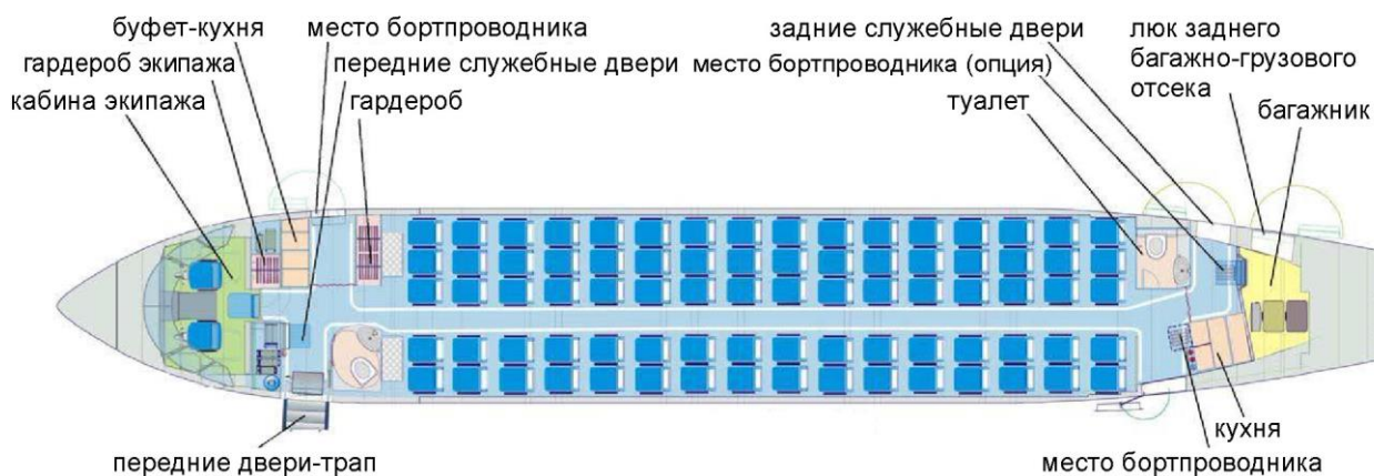
Рисунок 3.19 – Компоновка самолета Ан-148 на 80 пассажиров (шаг кресел – 762 мм (30"))
