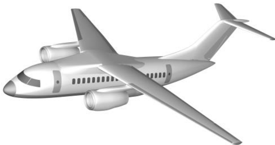
Рисунок 3.13 – Мастер-геометрия регионального пассажирского самолета
