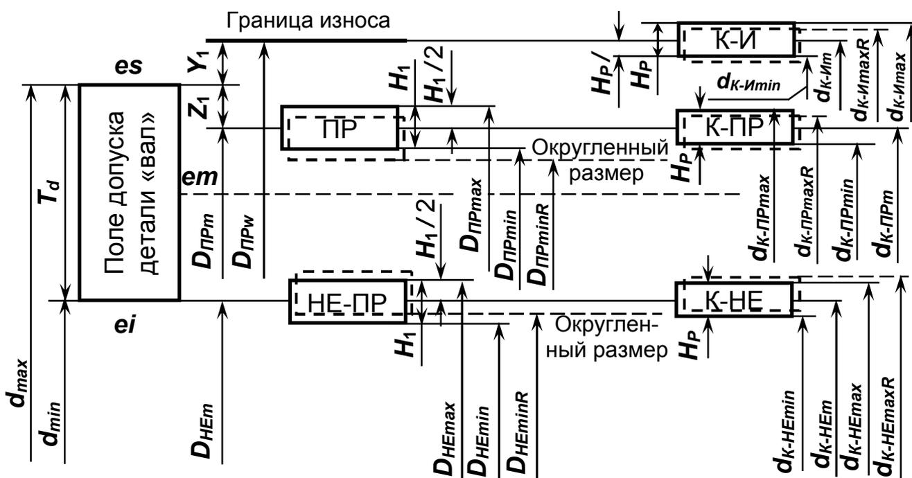
**Рисунок 2.2** – Схема для расчетов размеров рабочих калибров скоб и колец для контроля деталей «вал» и контрольных калибров-пробок для контроля рабочих калибров
