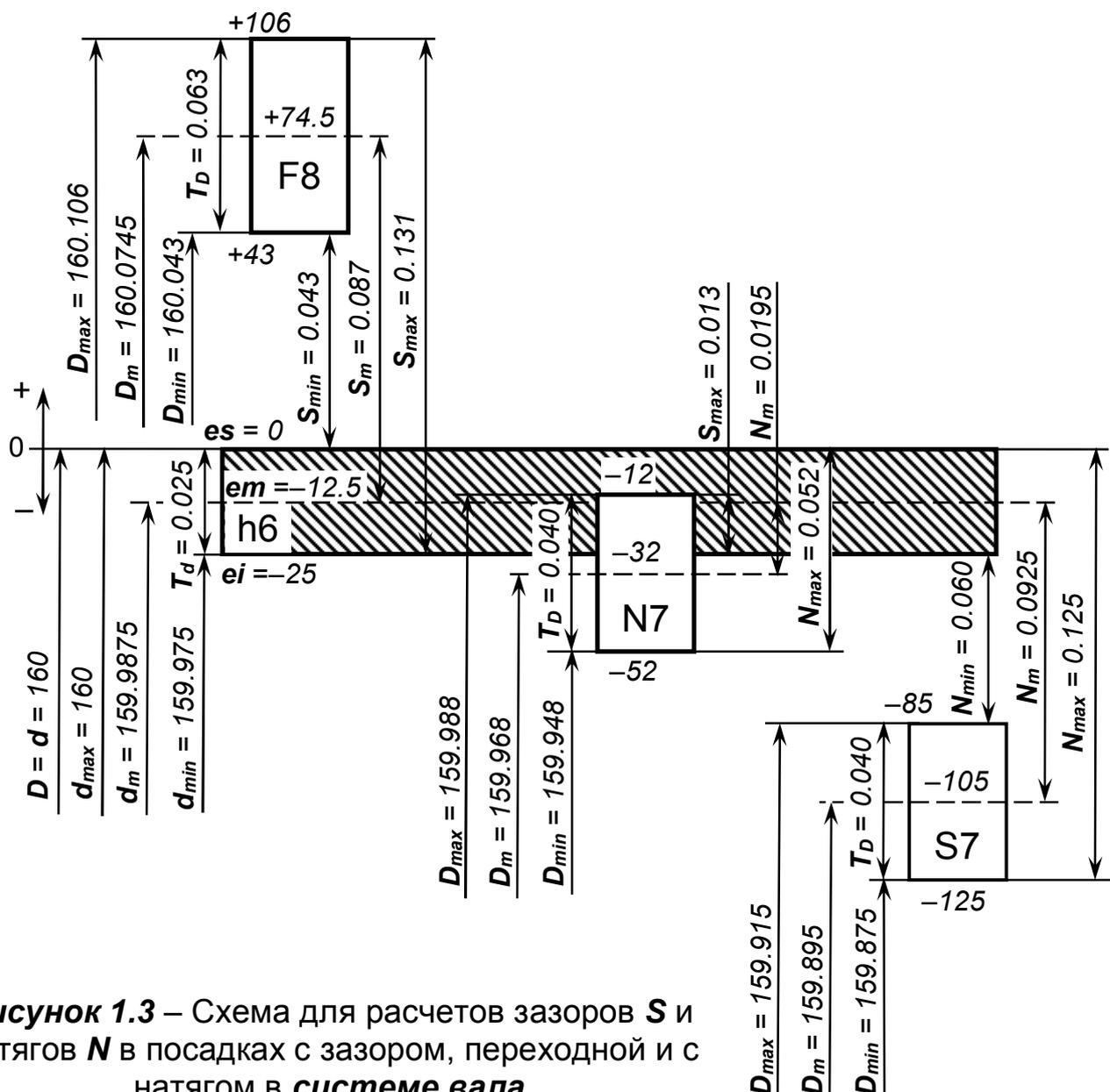
**Рисунок 1.3** – Схема для расчетов зазоров  $S$  и натягов  $N$  в посадках с зазором, переходной и с натягом в *системе вала*
